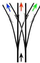
FIGURE 2.13 – Un `TrackElement` `[C/1,3]` : Croisement 1 entrée et 3 sorties
